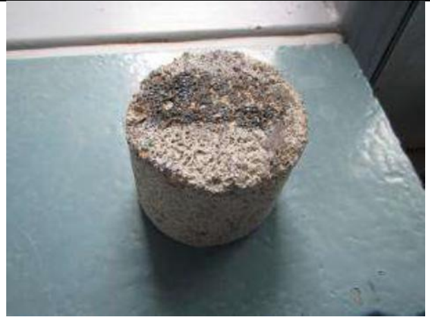
Kuva 16. Bitumisively pintabetonilaatan alapinnassa
