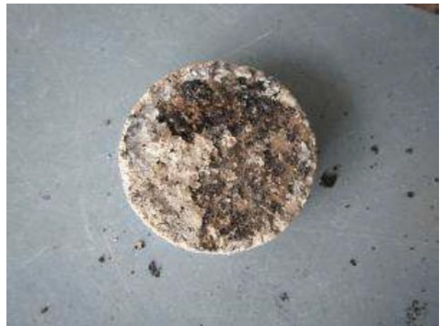
Kuva 70. Bitumikerros pintalaatan alapinnassa
