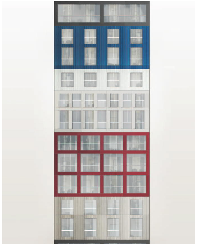
Väriskaalan tulee olla hillitty ja siinä tulee suosia metallin omia värisävyjä; metallinsävyt, kuparin ruskeat tai mattamustat. Lisäksi käytetään merikonttien värimaailmaa, kuten tiilenpunaista ja tummaa sinistä. Maalipinnat ovat kiiltoasteeltaan himmeitä.
