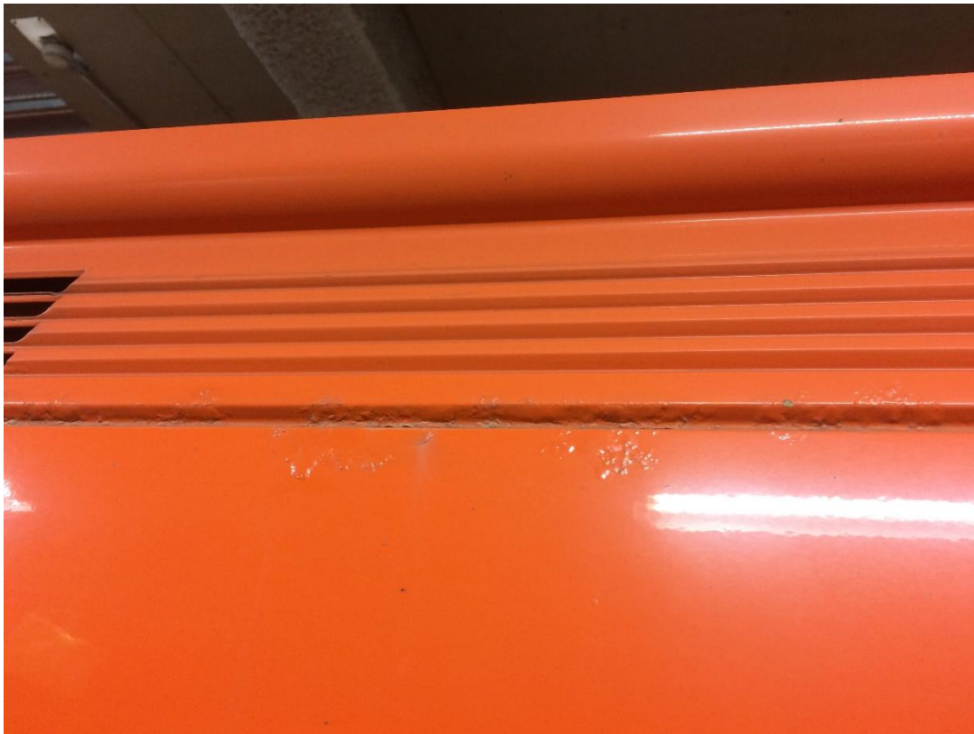
Kuva 1. M200-junan korin laaja-alainen sisäsyntyinen vaurio junan kyljen ylänurkassa.
